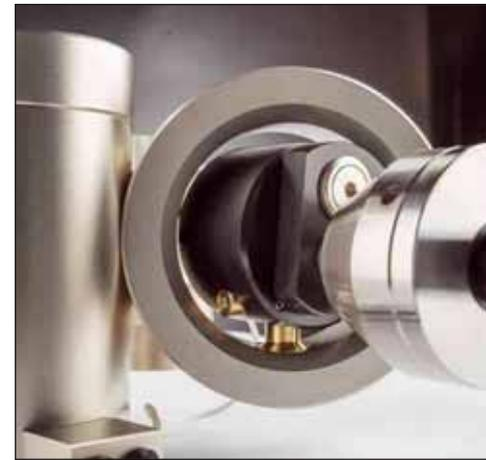
Unten auf dem zentralen Ring ist der Lagerdorn montiert
