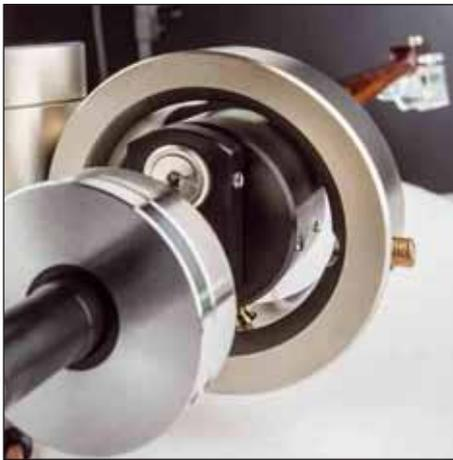
Rechts im Bild erkennt man die sonderangefertigte Schraube mit eingelassenem Magneten
