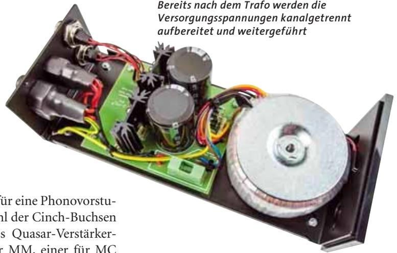
Bereits nach dem Trafo werden die Versorgungsspannungen kanalgetrennt aufbereitet und weitergeführt
