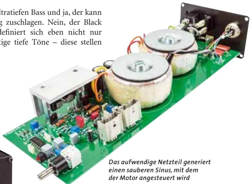
*Das aufwendige Netzteil generiert einen sauberen Sinus, mit dem der Motor angesteuert wird*
